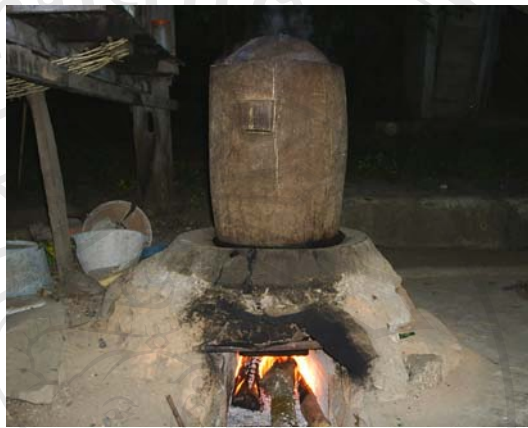
รูปภาพที่ 4.4 เตาปิ้งและปืบที่ใช้นึ่งเมียง
