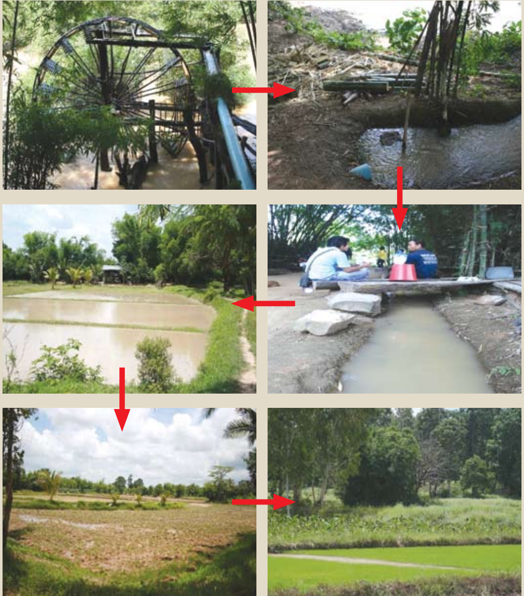
ภาพที่ 5-18 กระบวนการขั้นตอนการส่งน้ำเข้าพื้นที่นาโดยการใช้ภูมิปัญญาระหัดวิดน้ำ
