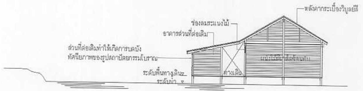
รูปที่ 5.5 รูปตัดอาคารแสดงสภาพปัญหาการต่อเติมอาคารตามแนวริมคลองของตลาดน้ำ
