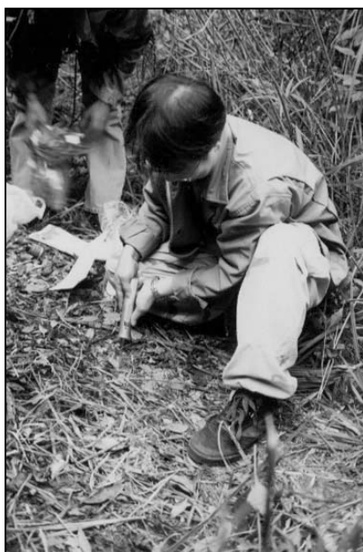
ภาพที่ 7 การใช้ soil hardness tester วัดค่าการอัดแน่นของดิน
