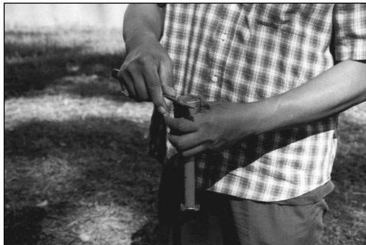
ภาพที่ 6 การปาดดินส่วนเกินจาก soil core ก่อนจัดเก็บตัวอย่างดินไปเข้าห้องปฏิบัติการ
