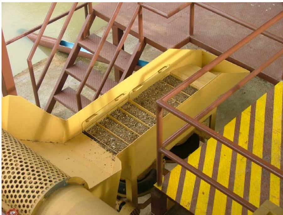
ภาพที่ 19 การแต่งแร่โดยใช้ จิ๊ก (jig) เป็นตัวคัดแยกดิน หิน และ แร่
