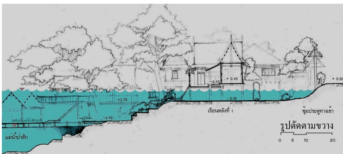
ภาพประกอบที่ 4.32 รูปตัดตามขวางแสดงระดับน้ำท่วมขังเดือนตุลาคม พ.ศ.2553
