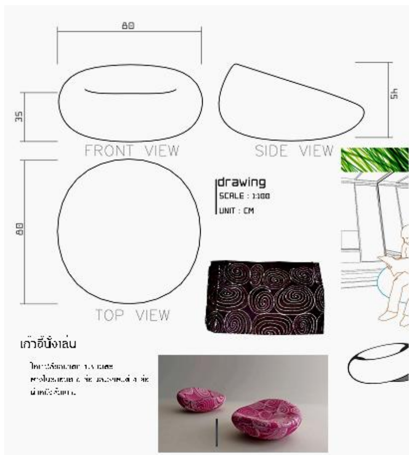
ภาพที่ 4.18 ภาพเขียนแบบเพื่อการผลิตเก้าอี้หนังเล่น และจำแนกวัสดุในการผลิตจริง
