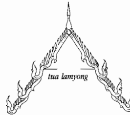
Source: Ibid. : appendix (13) --Figure 26 Bargeboard--
