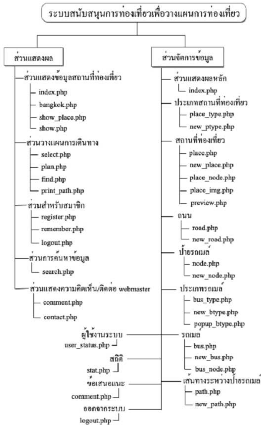
ภาพที่ 5.4 แผนผังโครงสร้างไฟล์ชุดคำสั่งของระบบ
