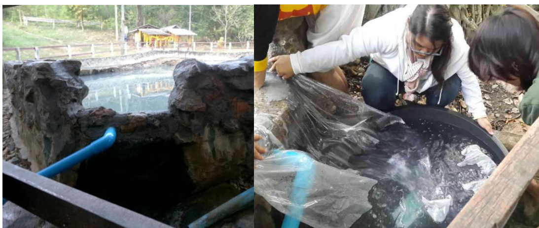
ภาพที่ 4-16 ลักษณะขอบบ่อ (ซ้าย) และการหาอัตราการเกิดน้ำพุร้อน (ขวา) ของพุร้อนหนองหญ้าปล้อง ใช้เวลาที่บันทึกได้ คำนวณตามสูตรเพื่อหาอัตราการเกิดน้ำพุร้อน ทำซ้ำเพื่อหาค่าเฉลี่ยของข้อมูล
