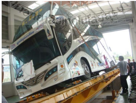
ภาพที่ 2.26 การทดสอบการทรงตัวของรถโดยสาร ที่มา: สุกกิจ รูปจันทร์ (2559)
