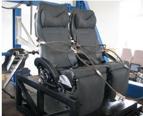
ภาพที่ 2.27 การทดสอบความแข็งแรงของจุดยึดที่นั่งกับโครงสร้างรถ ที่มา: ศูนย์บริการวิชาการออกแบบและวิศวกรรม (2554)
