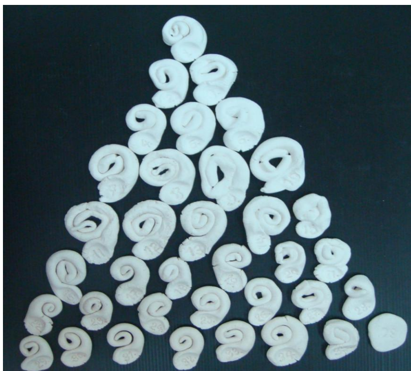
ภาพที่ 4.12 แสดงสีของเนื้อดินปั้นหลังเผาที่อุณหภูมิ 1,230 องศาเซลเซียส บรรยากาศ Oxidation
